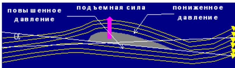
Подъемная сила зависит также от угла между потоком и плоскостью крыла - а, так называемого угла атаки.
